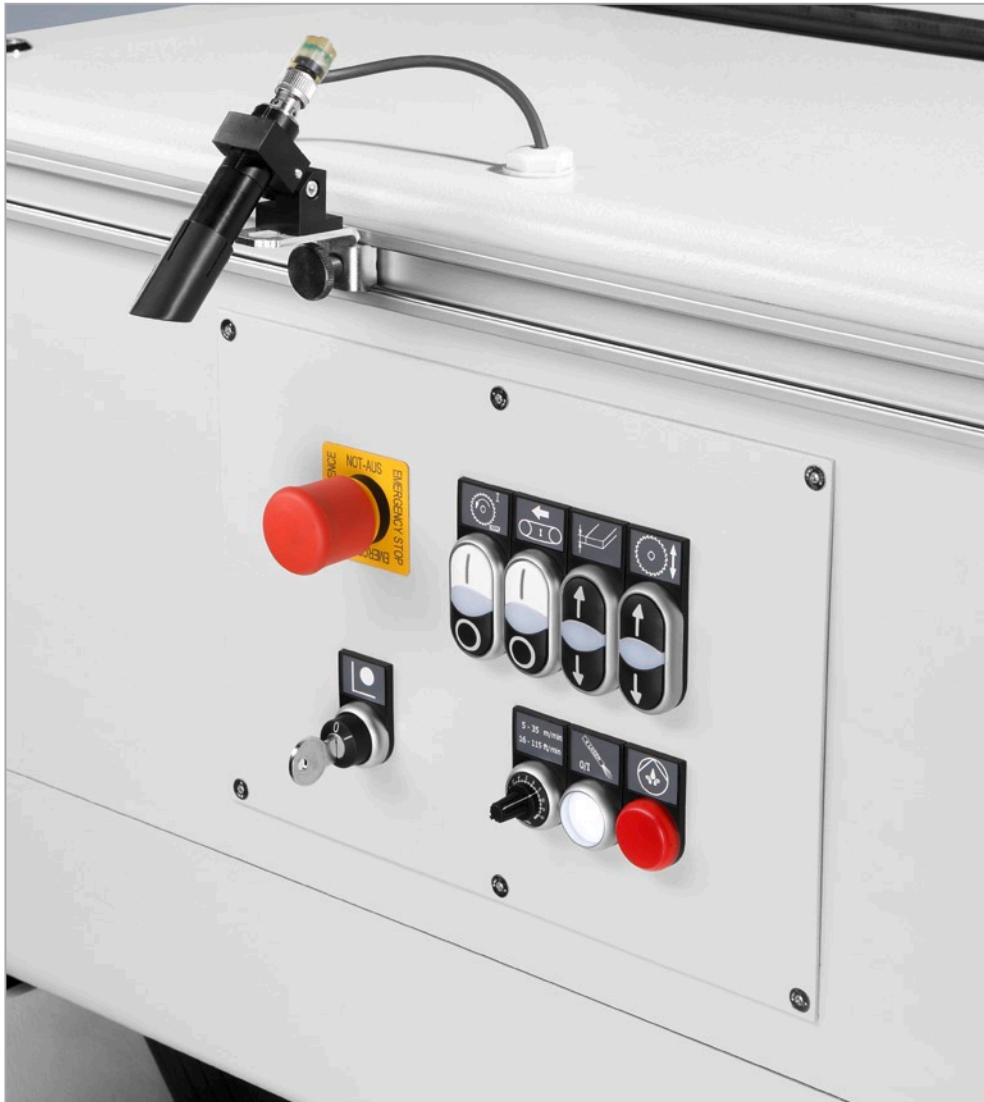
Elementos de control colocados de manera central
