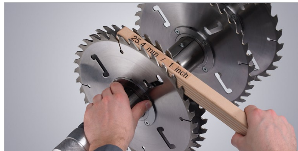
Introducir maderas de prueba y ajustar hojas de sierra
